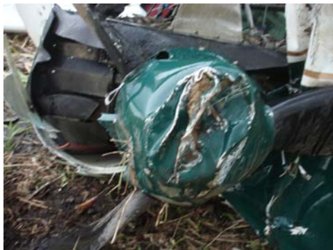
Daño del spinner de la hélice.
