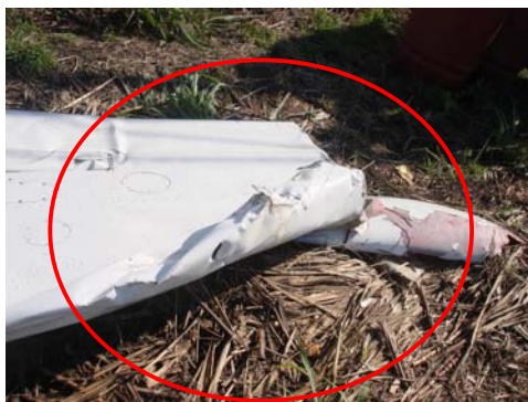
Plano o ala derecha con daños en su primer impacto contra el suelo.
