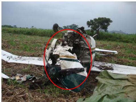
Vista frontal y desprendimiento de motor.
