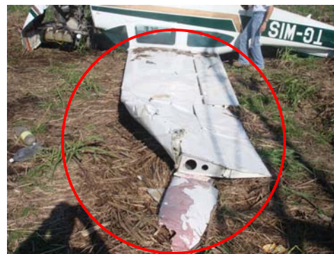
Plano o ala derecha con daños en su primer impacto contra el suelo.
