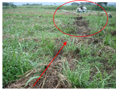
Rastro de tren de aterrizaje e impacto del tren de aterrizaje
