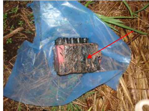
Vista de la batería con daños por corto circuito interno.
