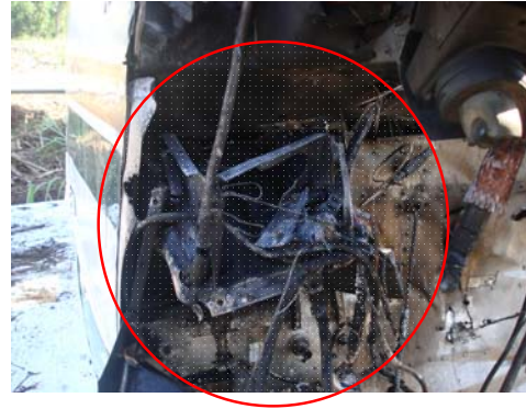
Vista del conato de incendio por daño en al batería.
