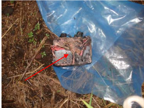
Vista de la batería con daños por corto circuito interno.
